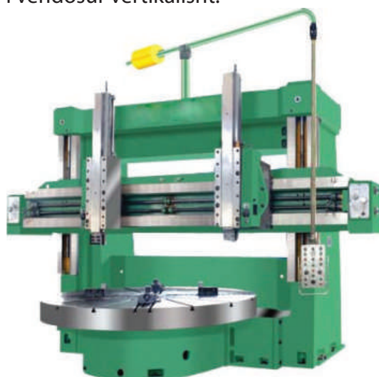
Figura 1.29: Torno karosale me dy shtylla
