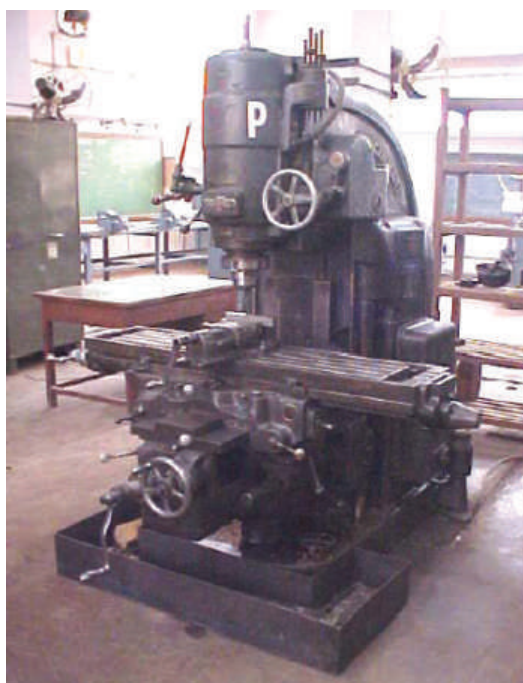
Figura 3.30: Makina frezuese e thjeshtë vertikale
