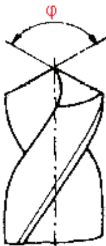
Figura 2.25: Këndi i majës së puntos
